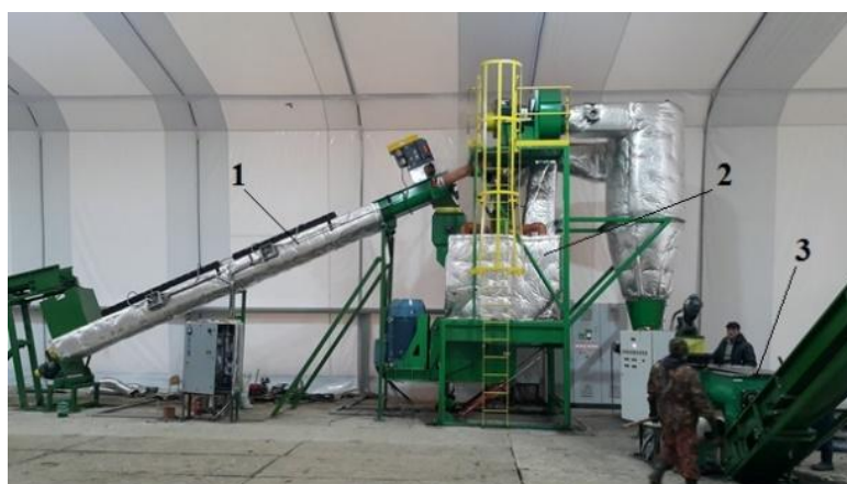
Рисунок 21 - Вид технологической линии на оз. Савельево: 1 - безынерционная сушилка, 2-дезинтегратор кинематический, 3-смеситель поточного действия (Патент № 2336253 РФ)
