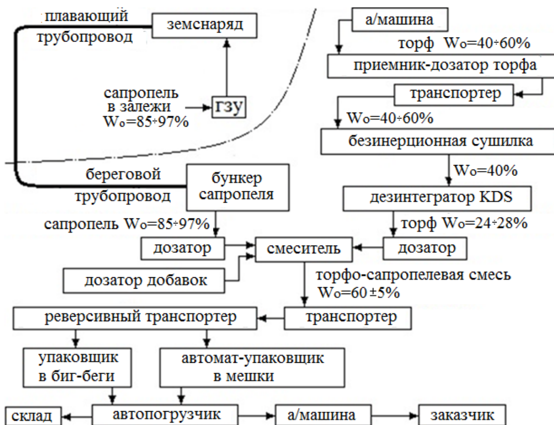
Рисунок 19 – Принципиальная технологическая схема производства торфо-сапропелевых удобрительных смесей
