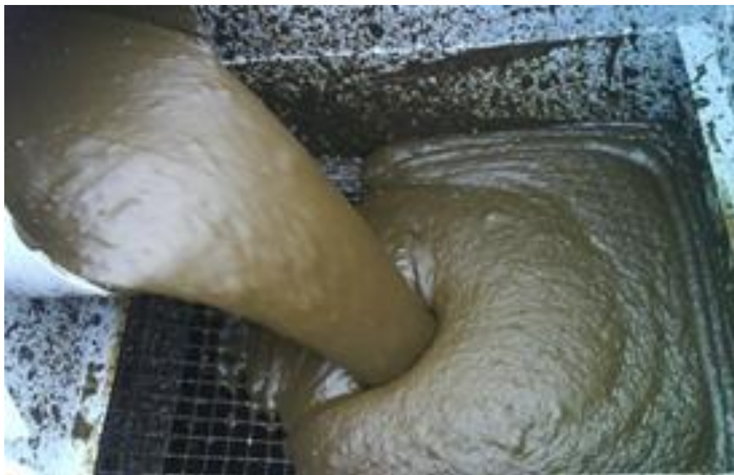
Рисунок 20 - Подача сапропеля естественной влажности в накопительный бункер
